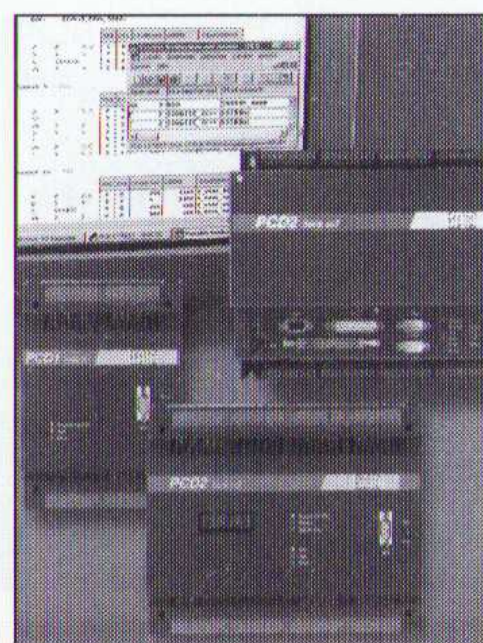
De zelf ontwikkelde PLC van SAIA.
