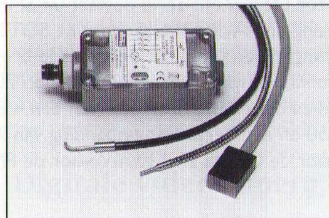
De IFA is een kleine, flexibele fotocel.
